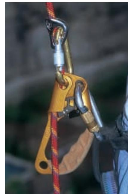
Abb. 3: Redundanz – eine Steigklemme, darüber eine TIBLOC-Klemme (PETZL). Sollte die Steigklemme versagen, greift die TIBLOC-Klemme.
