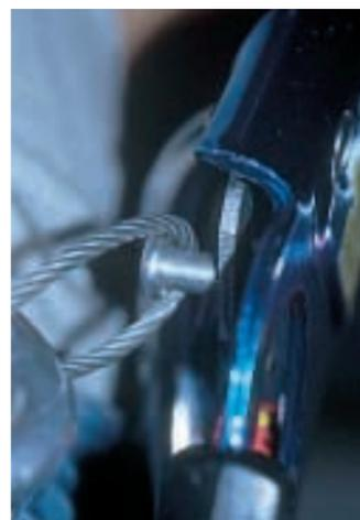
Abb. 2a/2b: Eventuelle Unfallursache: Eine Gürtelschleufe oder die Schleufe eines Drahtklemmkeils oder etwas Ähnliches verfängt sich bei Sturzbelastung am Schließ- und Öffnungsgriff der Steigklemme und verhindert so ein Greifen der Zahnklemme am Seil.
