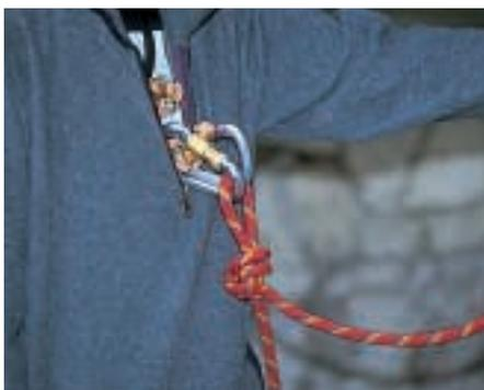
**Abb. 5a/5b: Wo Karabiner zum Anseilen verwendet werden – beim Toprope-Klettern und auf Gletschern – ist Redundanz notwendig, d.h. zwei Karabiner parallel.**
