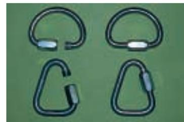
**Abb. 6: Schraubglieder (auch Schließring oder „Maillon Rapide“ genannt) zur Befestigung des Klettersteigsets am Anseilgurt, wenn man – wegen der Gefahr des unerwarteten KnotenlöSENS – kein Seilstück und keine Bandschlinge verwenden will.**
